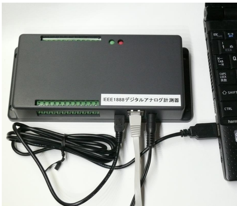
図 3: 本装置をパソコンと USB 接続する (AC アダプタも接続する)
